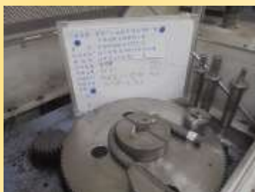
鋼筋彎曲試驗
